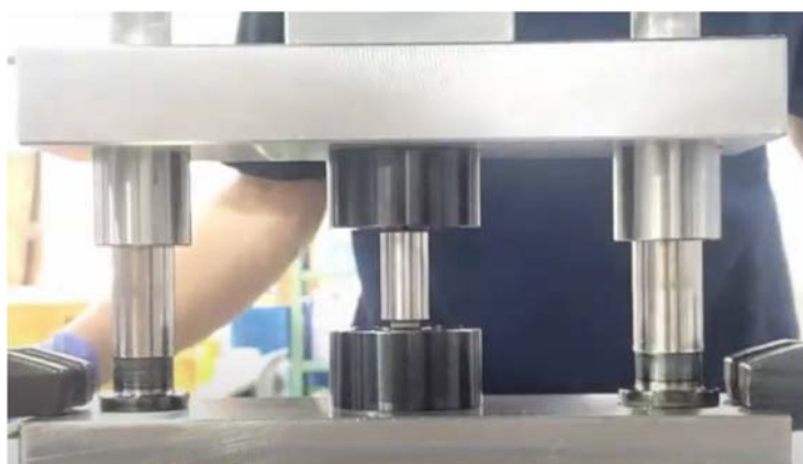
写真：カシメ接合の作業風景
