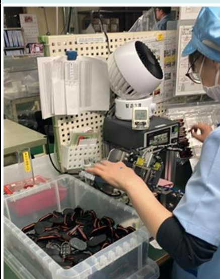
専用器具を使った検査(圧着度)
